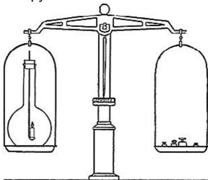
В ложечке закрепляется свеча. Весь прибор в сборе заранее уравнивается на весах (рис. 8). Когда учащиеся приходят к выводу, что опыт следует проводить в закрытом приборе, учитель достаёт весы с колбой, зажигает свечу, закреплённую в ложечке, вносит в колбу и плотно закрывает. Учащиеся видят, что равновесие весов не нарушается в ходе всего эксперимента.
